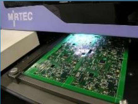
5 lignes de contrôle AOI (sérigraphie, pré reflow et post reflow), contrôle de l'ensemble de la production CMS
